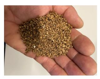
L'alternative aux granulés de plastique est basée sur une matière première renouvelable, le liège, et est biodégradable.
