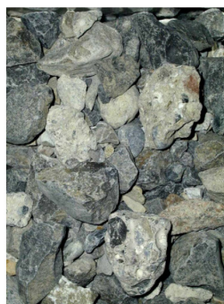
Le béton RC-C est fabriqué à partir de granulats de béton et le RC-M à partir de granulats mixtes.
