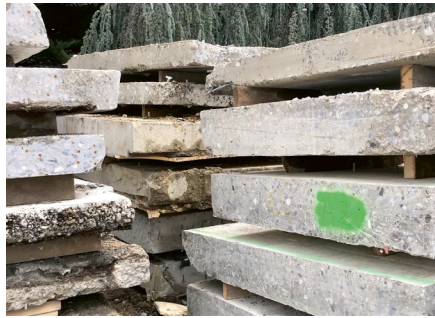
Dalles en béton pour réemploi, source : © Faz architectes
